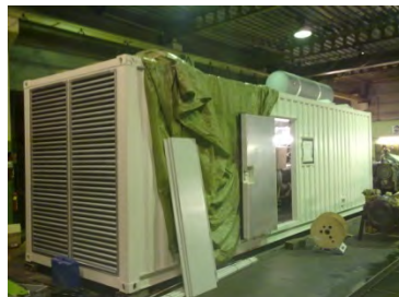
600 kVA Schallgedämmt 30 Fuß Container
